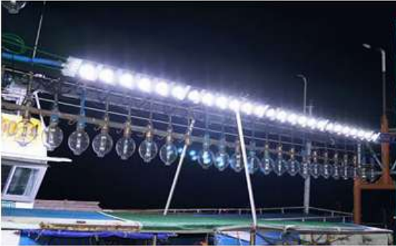
채낚기어선 LED 집어등 설치
