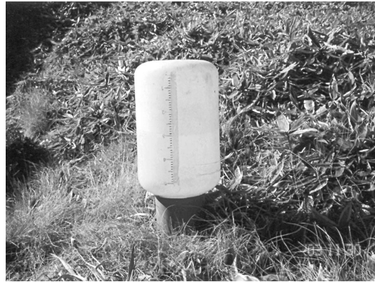
<그림 4> 관수형 침투계를 이용한 투수시험
