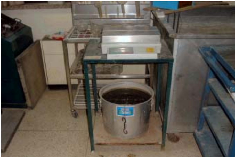
그림 4.6 비중 및 흡수율시험 모습
