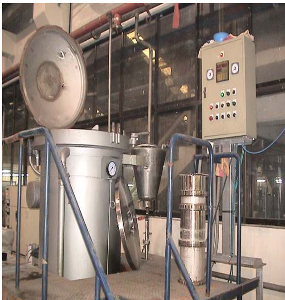
<그림 7> 정련 기기 모식도
