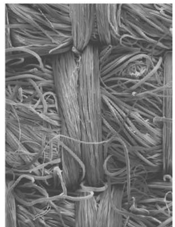
<그림 18> 신서란 방적사로 제작된 직물(좌로부터 시료1, 2, 3)
