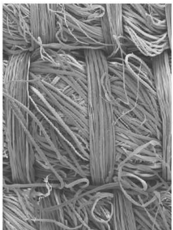
<그림 18> 신서란 방적사로 제작된 직물(좌로부터 시료1, 2, 3)
