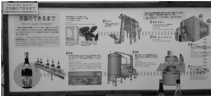
〈사진 5〉 아와모리 제조 과정
