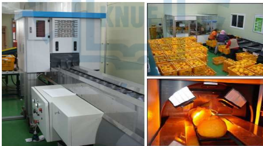
[그림 34] 비파괴광센서 선과기(좌), 한라봉 선과 모습(우상), 비파괴광센서통과모습(우하)
