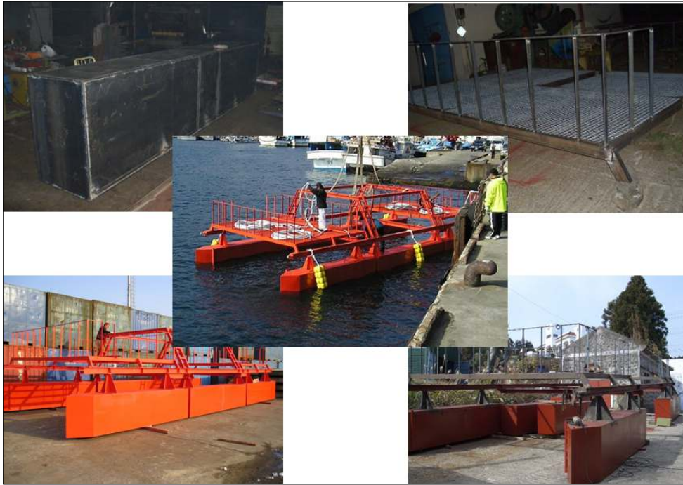
fig. 4 침하식 해면 부양 구조물 제작 및 실제 모습
